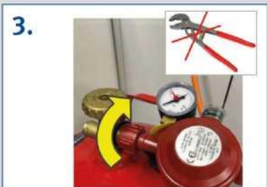
Skru nu trykregulatoren af med hånden – drej med uret, brug ikke tang
