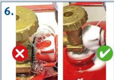
Kontroller altid til sidst, at forbindelsen er tæt – skummet der sprøjtes på, må ikke danne bobler
